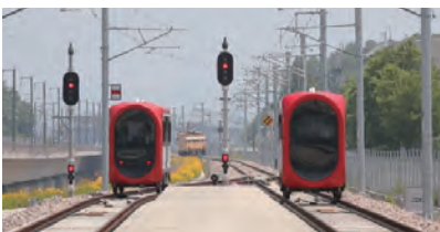
▲ 열차 간 분기기제어를 시험 중인 축소시험차량 (오송 철도종합시험선로)
