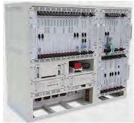
〈그림 6〉 ATC/CBTC 통합형 차상신호장치
