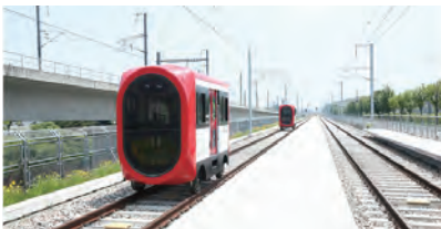
▲ 열차 간 정밀 간격 제어를 시험 중인 축소 시험차량 (오송 철도종합시험선로)
