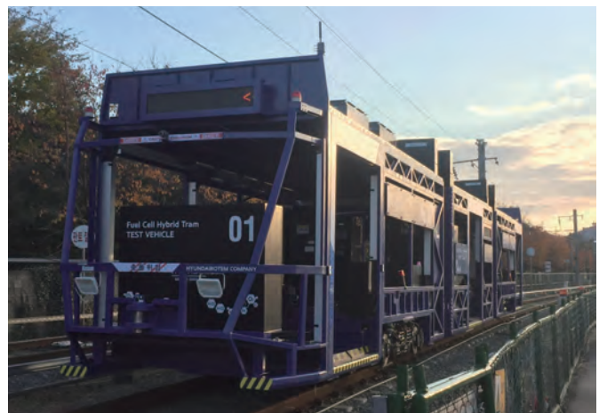
〈그림 12〉 창원공장 내 주행시험선에서 시험 중인 수소전기 트램 시험차량
