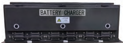
▲ 원강선 고속열차 동력차용 축전지 충전기
