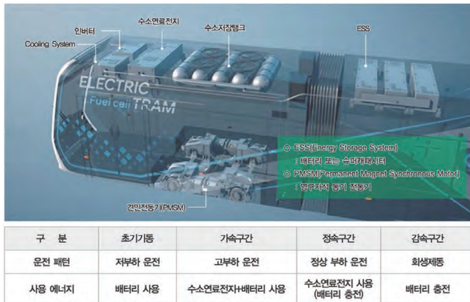
〈그림 6〉 수소전기 트램의 구동원리 및 운행제어
