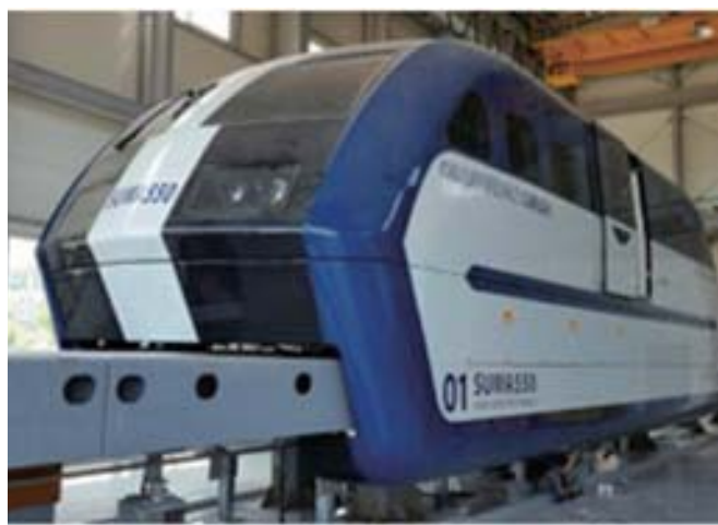
<그림 3> 저진공 튜브 공력시험장치 및 LSM 자기부상차량
