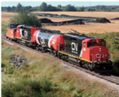
<그림 4> 캐나다 천연가스 기관차 시범운전 및 GE社の 천연가스 추진 Retrofit(개조)로 인한 연료비 50% 절감 성과
