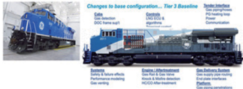
<그림 4> 캐나다 천연가스 기관차 시범운전 및 GE社の 천연가스 추진 Retrofit(개조)로 인한 연료비 50% 절감 성과
