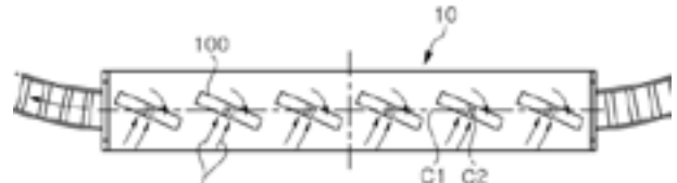
그림 5. 곡선선로에서의 날개위치(중간 차량)
