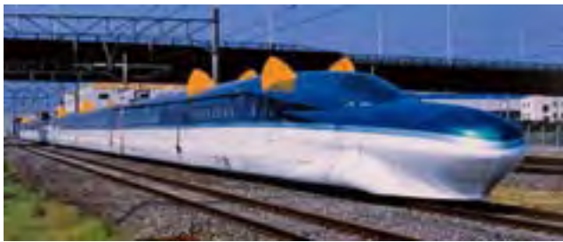
그림 6. 공기저항 제동장치(Fastech-360) 출처: wikipedia
