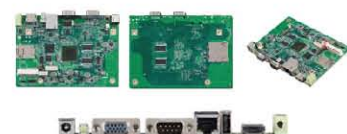
철도차량 인포테인먼트 및 HMI시스템 헤드유닛 장치
