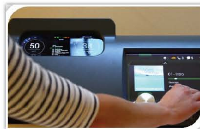
철도차량 인포테인먼트 및 HMI시스템 헤드유닛 장치
