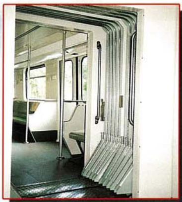
Gangway Diaphragm : 고속전철, 전동차, 경전철, 객차용 통로 연결막
