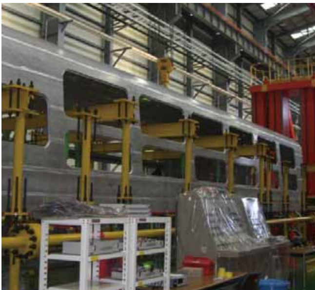
[그림 8] 이중창이 있는 Cafeteria Carbody 차체 하중시험 모습
