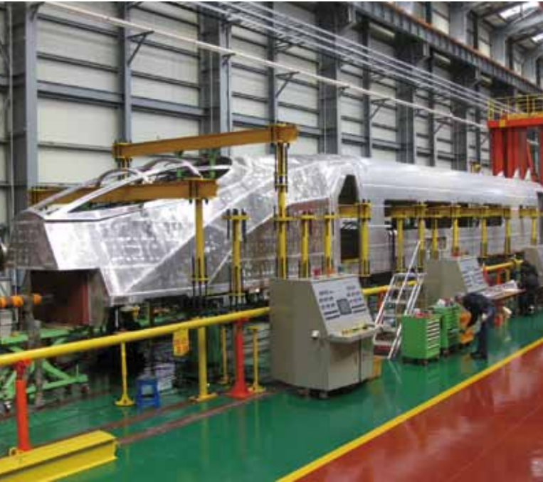
[그림 6] TC 하중시험 모습
