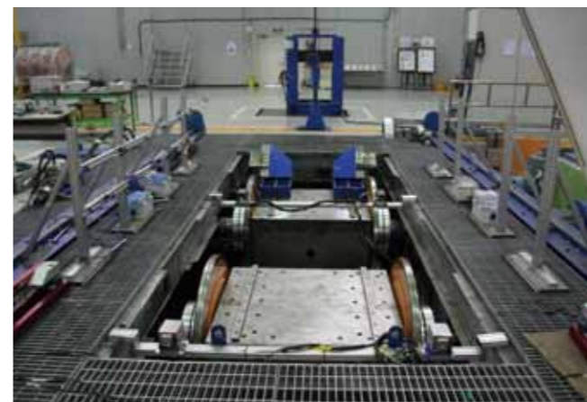
[그림 12] KRRI Roller Rig 시험장비
