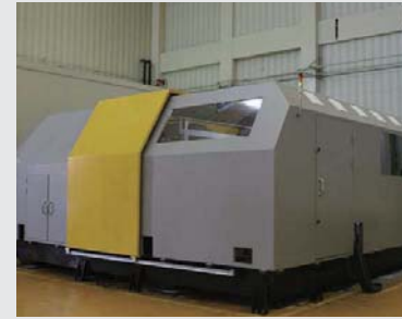
고속 레일-차륜 접촉 시험기 High Speed Rail-Wheel Contact Simulator
