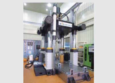
대형 삼축압축시험기 Large Triaxial Testing System
