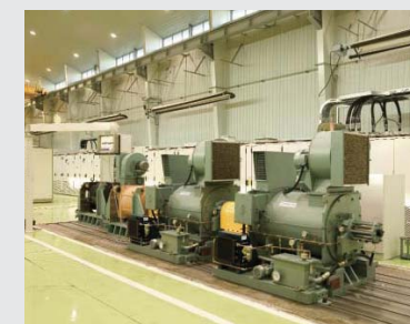
견인전동기 성능시험기 Traction Motor Tester
