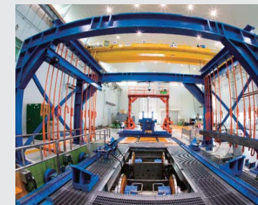
대차동특성 주행시험기 Bogie Dynamic Simulator
